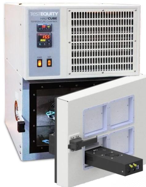
Компактный вариант ML4054B установленный на дверцу термопечи комплекса MLT8000.
