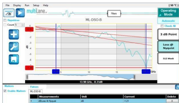
Режим измерения S-параметров
